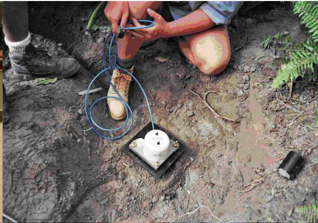
Clinometro in uso sull'isola vulcanica di Montserrat
