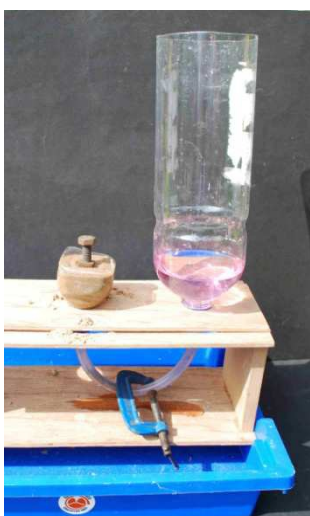
En hjemmelaget versjon av oppsettet. Klargjort til å stenge skruklemma og fylle opp flasken til høyre. (Foto: Peter Kennett)
