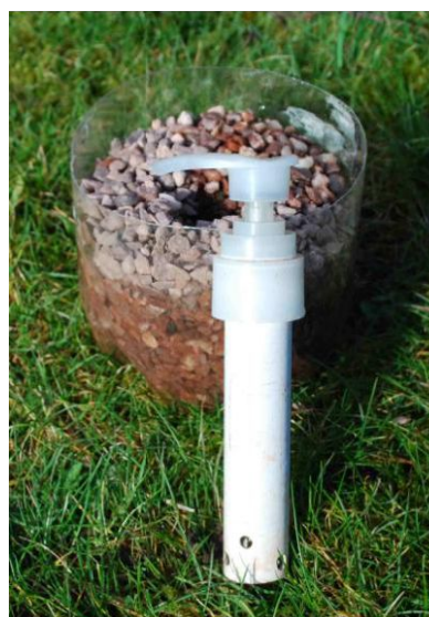
Aquí es mostra una peça de tub perforat al voltant del tub de la bomba, per tal d'evitar l'obstrucció (vegeu "Material")
