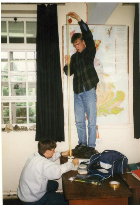
Estudiants testejant el rebot d'una bola de coixinet d'una mostra de roca (usant un tub de plàstic de 2m de llarg)
