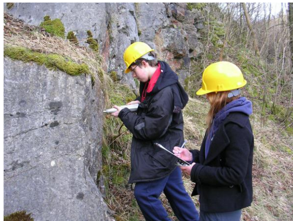
Estudiants fent servir un Martell Schmidt per mesurar la resistència d'una calcària, com a part d'un exercici de projecte d'un túnel
