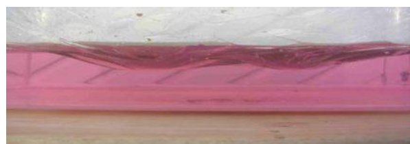
Foto 7: "Estructures de càrrega" formades a mesura que la sorra enfonsa el plàstic (vista lateral)
