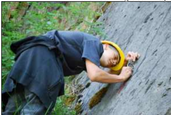
Mesurant l'angle de cabussament en roques inclinades (Peter Kennett).
