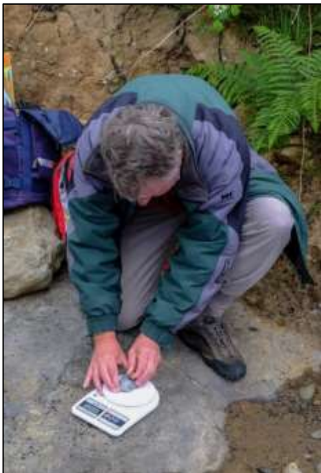
Usando una balanza electrónica para medir la fuerza necesaria para rayar un canto de caliza con un fragmento puntiagudo del till, Traeth Bychan, Anglesey, GB. (Peter Williams).
