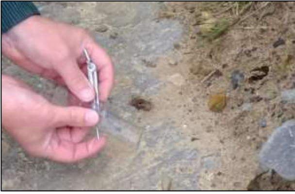
El método usando un compás y una regla para medir la profundidad de las estrías glaciares, Traeth Bychan, Anglesey, GB. (Peter i Maggie Williams).
