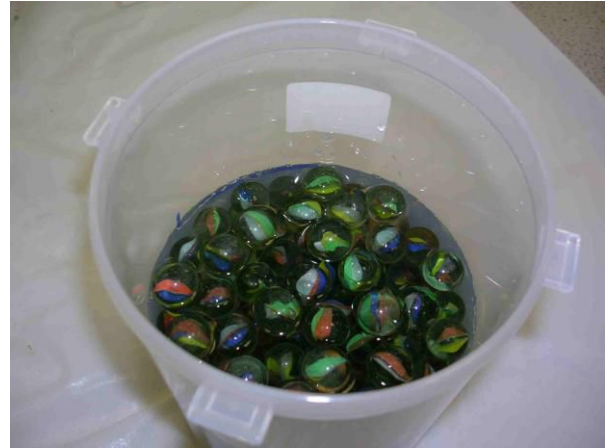
Mesura de la porositat d'un recipient amb boles de vidre
