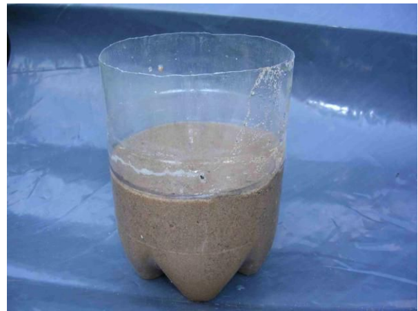
Mesura de la porositat d'un recipient amb sorra seca (Fotos: P. Kennett)
