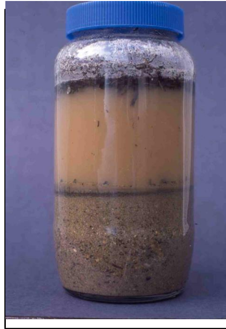
Un pot de cafè amb sòl després d'agitar-lo i deixar que sedimenti.
