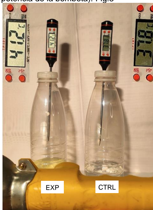
Fig.3 Exposades a la llum d'una bombeta calenta, les dues ampolles mostren un augment de temperatura diferent (Foto: Giulia Realdon CC BY-SA)
