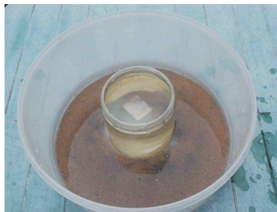
El model de "corba de riu contínua" preparat amb una capa uniforme de sorra i mena densa
