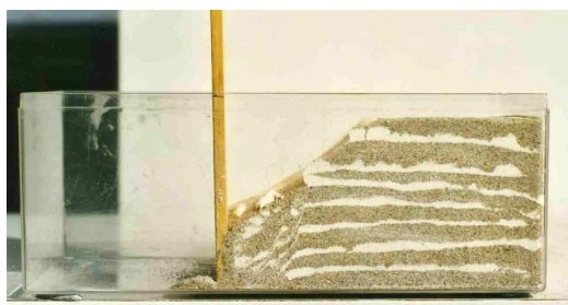
Fasi successive nella formazione di una faglia diretta – e di una "rift valley"
